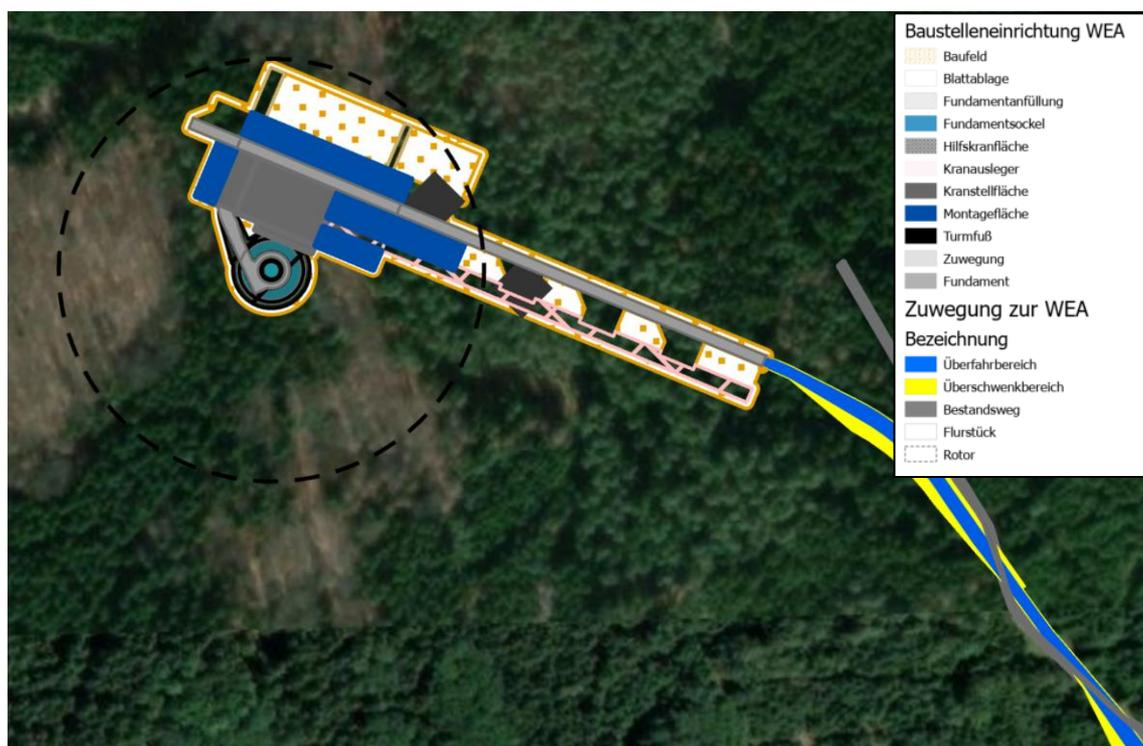
**Abbildung 2:** Anlagenstandort WEA 1 mit Eingriffsflächen, Quelle: Uhl Windkraft 2023
