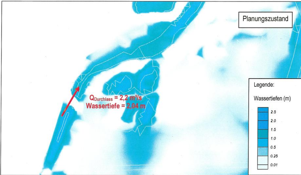
Abbildung 5: Überschwemmungssituation am Durchlass bei Lech-Fkm 18,00
